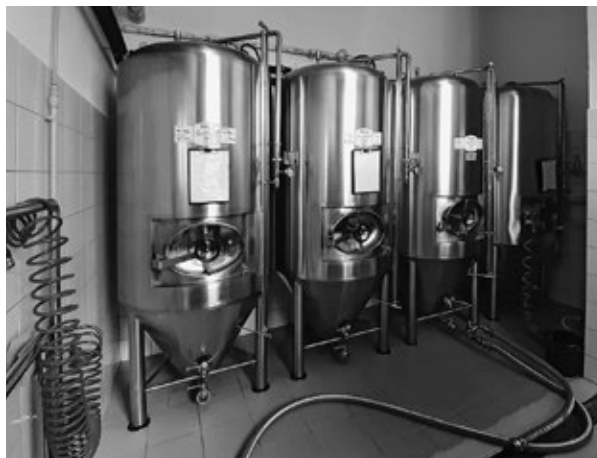
Varna minipivovaru Zlosin o objemu kotlů 500 litrů. Foto: archiv autora.
